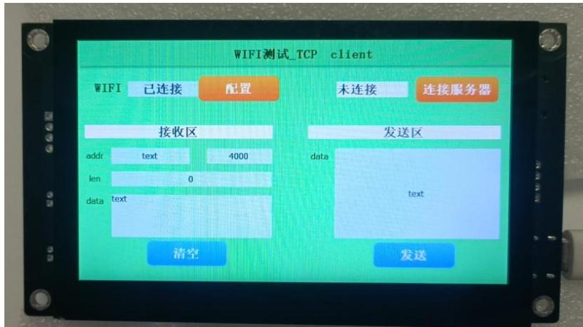
2、串口屏上电后，系统会系统连接 WIFI（系统保存上次的 WIFI 连接信息，会在下次上电的时候自动连接 WIFI）。如果显示未连接，需要点击配置按钮，输入 WIFI 名称和密码（一般首次使用时，需要配置），然后点击配置重连接按钮。
