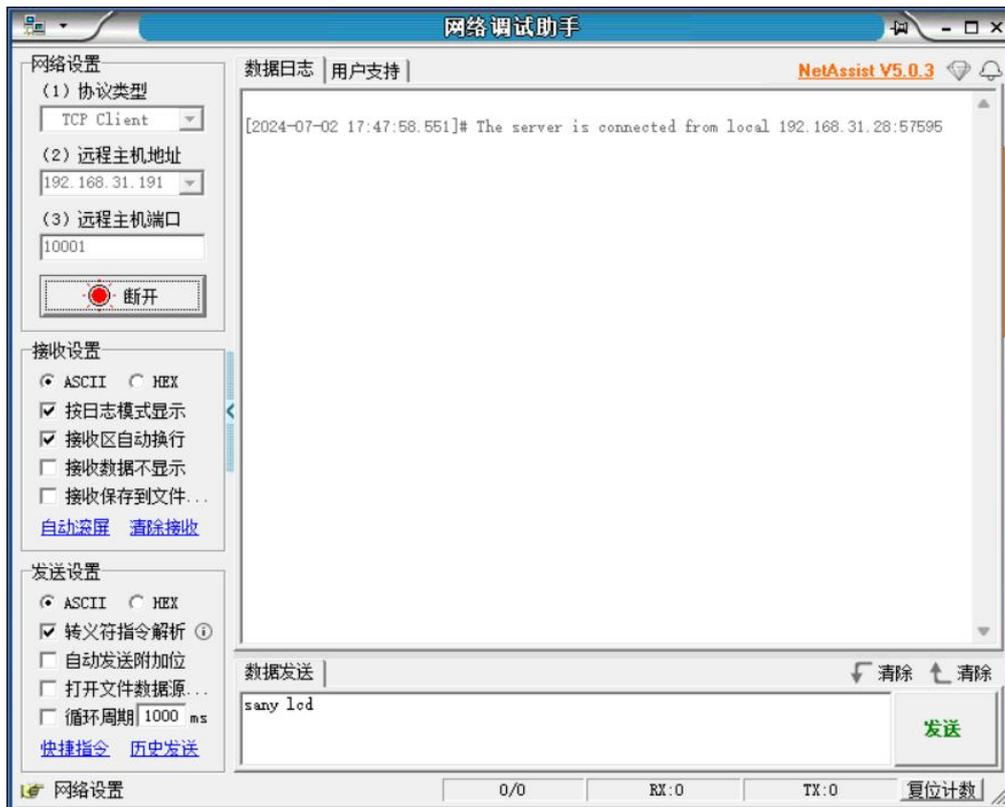
11、网络调试助手发送字符串 `sany lcd`。串口屏则会收到 TCP 报文，显示收到报文的地址为 `192.168.31.28`，端口号 `56975`，数据长度 `8`，数据类容为 `sany lcd`；
