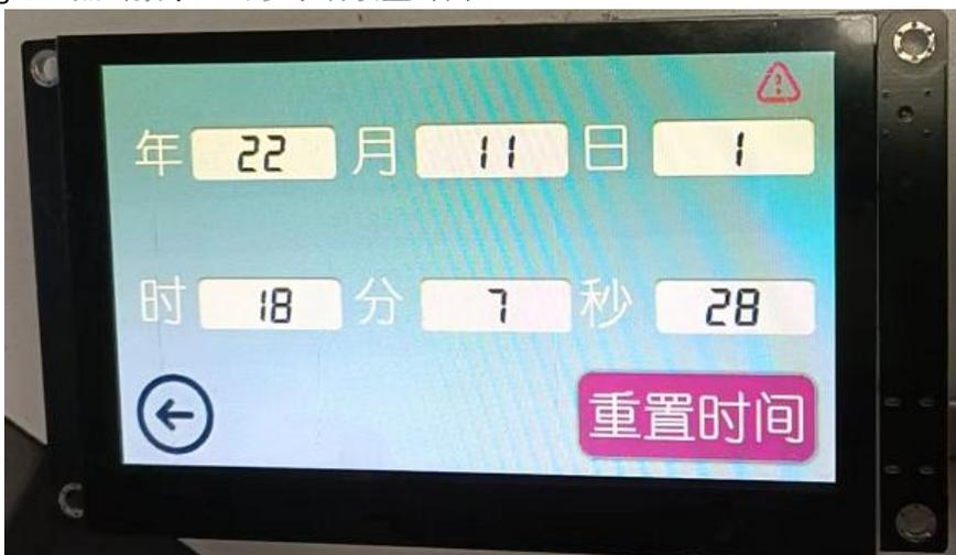
修改 RTC 时间也能通过串口修改。指令格式可以串口屏系统指令 `sset`，系统指令用法可以参考实验 1。也可以通过自定义协议，在脚本代码里修改 RTC 系统变量的值，自定义协议用法可以参考实验 2。
