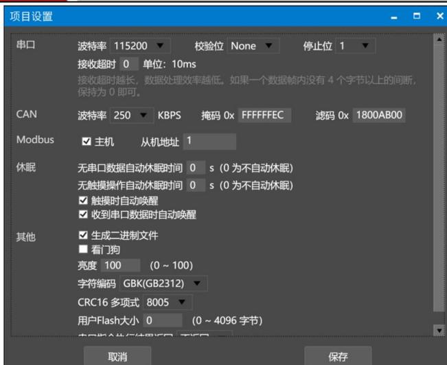
这种配置方式，只能设置过滤器 0 的屏蔽位模式。适用于过滤器简单的设置，优点是配置简单
