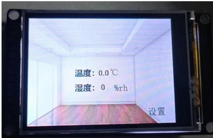
用 VP 软件将例程下载到串口屏，连接温湿度模块，即可看到温湿度模块的参数。
